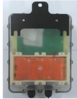
图 10、将其中一只挂耳对应测控终端上部安装孔放置，并用螺钉固定。
