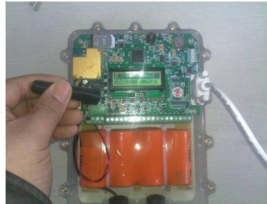
图 6、连接流量计、脉冲表或其它变送器接线。对测控终端进行参数设置，详见第三、四章。
