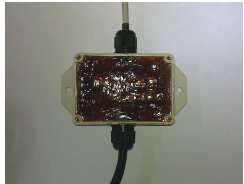
图 2、将测控终端的连接线与流量计（或变送器）的连接线连接，然后填满黄油。
