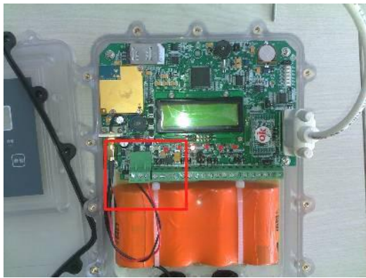
图 5、红色方框位置连接电池组供电电源。
