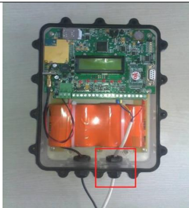
图 7、设参完毕，取下串口设参线。
