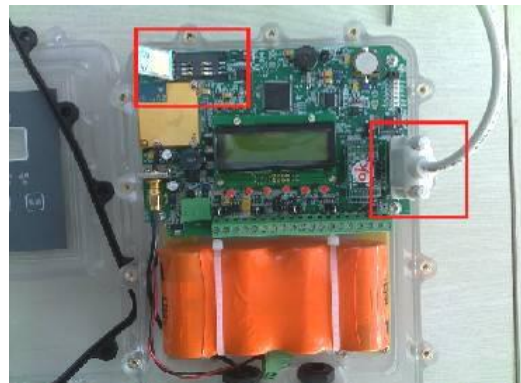
图 4、红色方框位置安装 SIM 卡。串口设参时安装 DATA-F001 串口设参线。
