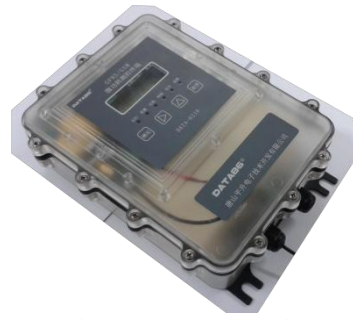
图 12、挂耳安装完毕。现场安装时，利用挂耳的 3 个固定孔并用膨胀螺栓或钢钉即可将测控终端固定到墙壁上。
