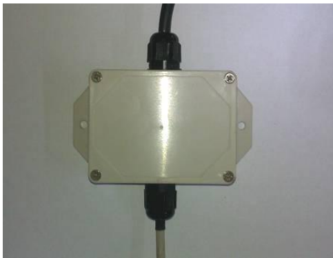
图 3、 拧上螺丝，注意使 4 个螺丝均匀受力。建议优先安装对角螺丝。
